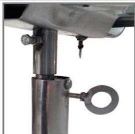
Coluna Mecânica giratória em 360 graus, regulagem da altura contínua com travamento exclusivo, projeto mecânico por rasgo de chaveta usinado, acionado por manípulo, patenteado. Flange estampada chapa e = 2 mm – coluna tubo 2” x 1,5 de parede – Eixo assento barra maciça 1 “– Base 5 patas tubular tubo 1 “x 1,5 mm de parede .
