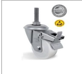
Garfo fabricado em chapa estampada e cabeçote com dupla pista de esferas e. Eixo da roda parafusado. 100 % inox AISI 304. Rodetes em NT - Nylon Técnico. Dureza: 75 Shore D. (-40°C a +110°C) Produzidas com revestimento e núcleo em nylon poliamida 6.0 de alta qualidade. Rodam com muita facilidade exigindo menor esforço para manobras e movimentação. Ideais para aplicações em ambientes úmidos. São resistentes a graxas, óleos, sais e alguns tipos de ácidos.
