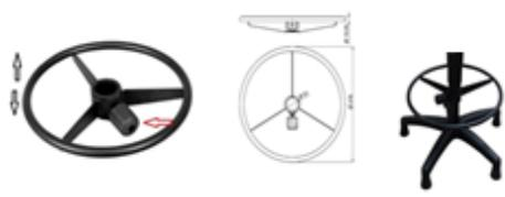
**Padrão:** Aro em aço estrutural SAE 1010/1020, altura regulável, para apoio dos Pés. Sistema de fixação devidamente projetado e atualizado do aro à coluna, com bucha bipartidas de material ante derrapante, com acionamento por manípulo de nylon que aciona, por sua vez, uma lingueta de aço a fim de evitar que os aros desçam com frequência ou sofram desgaste precoce.
