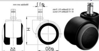
Produzido em Polipropileno Copolímero de alto impacto, com haste em aço SAE 1020 como acabamento zincado. São fornecidos com lubrificação interna permanente e capa de acabamento. A pista em rolagem em PU proporciona rolagem macia para os pisos frios.
