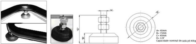
Além da estrutura do Golden Seat ser projetada e fabricada com tubo mecânico sem emendas, portanto sem soldas, com espessura de parede do tubo mecânico de 1,5 mm (cheque as cópias) os pés dos bancos são injetados em borracha sintética sobre parafusos de 3/8 de polegada que não se soltam, não se quebram com a primeira pancadinha, reguláveis para nivelamento.
