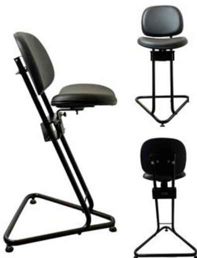
**Estrutura:** fabricada em aço carbono tubular mecânico com 1” e espessura de parede 1,5 mm de alta resistência, SAE 1010/ SAE 1020 soldadas por MIG.
