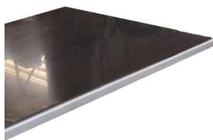
**Tampo em aço Inox:** Em Chapa de aço AISI 304 com espessura 1,2 mm com Bordas dobradas de 25 mm;
