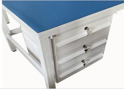
Gaveteiro: Com 03 gavetas fabricadas em Chapa de aço SAE 1006/1008 com espessura 1,2 mm, podendo ser fixada do lado direito ou esquerdo Medidas - A 160 mm x L 445 mm x P 400 mm
