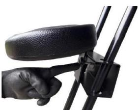
**3** - Colocar os dois manípulos de trava na caixa do assento, girar em sentido horário, até encostar no tubo da coluna, sem necessidade de aperto, a fim de evitar que a caixa se solte. Atenção antes de sentar-se observe se as “**linguetas de fixação**” estão encaixadas por completo, caso não esteja, o assento poderá cair e causar acidentes.
