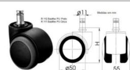
Produzido em Nylon, com haste em aço SAE 1020 como acabamento zincado. São fornecidos com lubrificação interna permanente e capa de acabamento. A pista em rolagem com acabamento em poliuretano PU proporciona rolagem sem riscos para os pisos frios e delicados.
