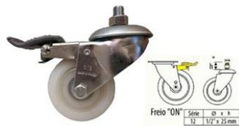
Garfo: Fabricado em chapa estampada e cabeçote com dupla pista de esferas, acabamento zincado. Eixo da roda parafusado.
